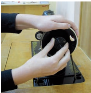
Рис. 46. Отделение махового колеса от главного вала
