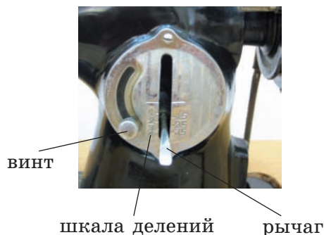
Рис. 53. Регуляторы длины стежка Правообладатель Национальный институт образования
