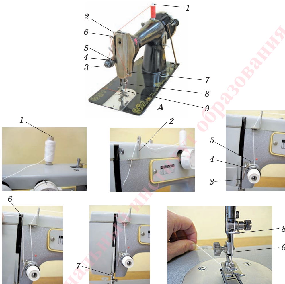
Рис. 49. Заправка верхней нитки:
